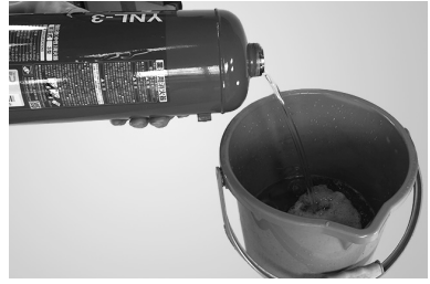
▲中の消火薬剤の移し替え
