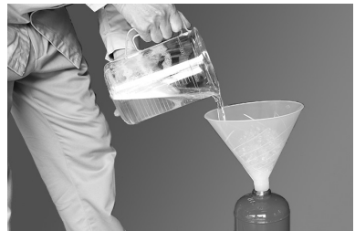
▲強化液消火薬剤の注入
