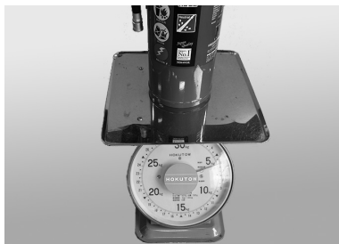
▲消火器の計量
