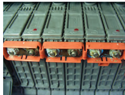
◀HV バッテリは1モジュールごとにプラス端子とマイナス端子を交互に配置し、それを金具とナットで接続する構造になっている
