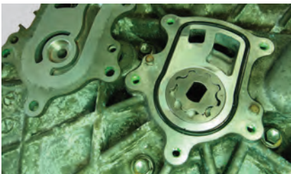
◀モータの外側端部に装着されている オイル・ポンプ
