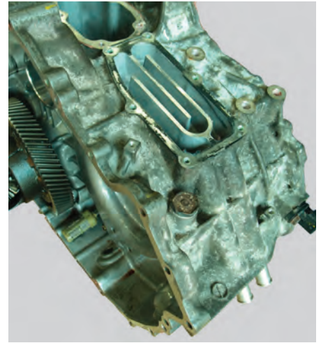
◀モータ・ケース上部の冷却用水路
