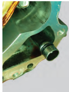
◀モータの外側端部に装着されている オイル・ポンプ
