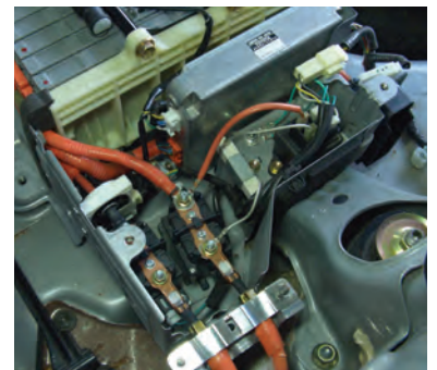
◀HV バッテリは1モジュールごとにプラス端子とマイナス端子を交互に配置し、それを金具とナットで接続する構造になっている
