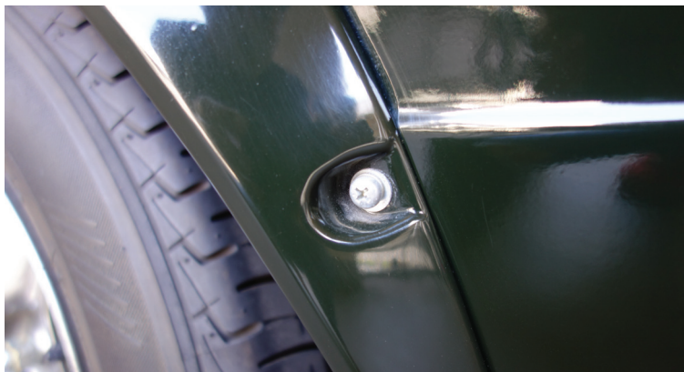
【ビスによるオーバーフェンダーの固定的取付の例】
